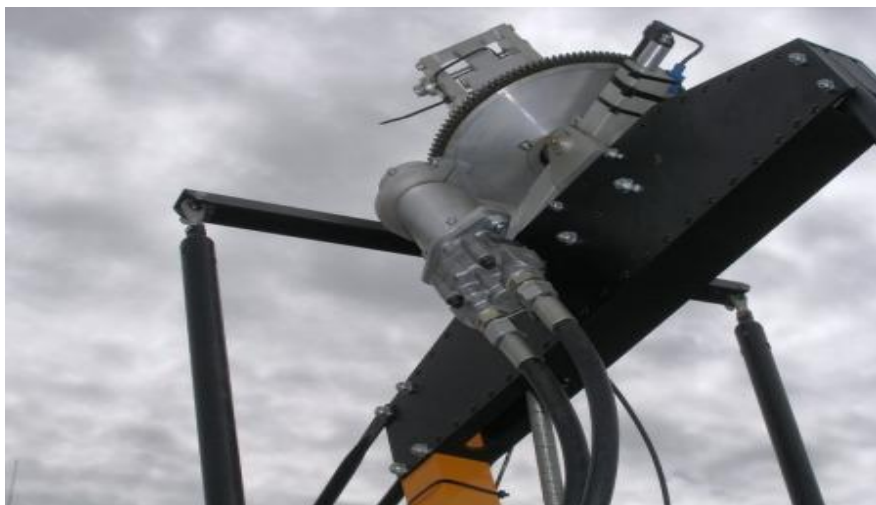
Рис 5.4. Система предварительной гидравлической раскрутки
