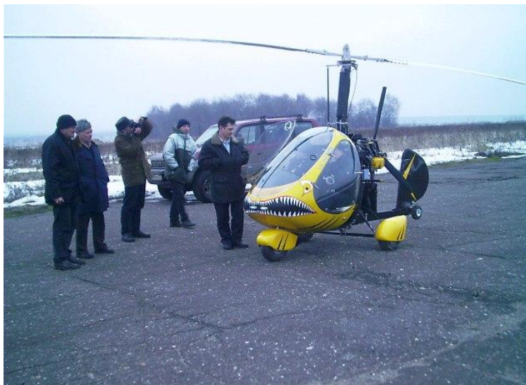
Рис. 1.2. «RAF 2000» – автожир с опасной центровкой
